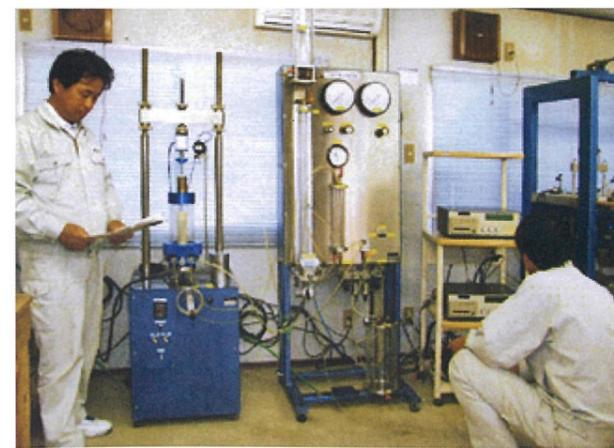
土質試験室=三軸圧縮試験
